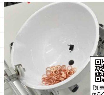
ボール回転式ガスケット整理からくり
